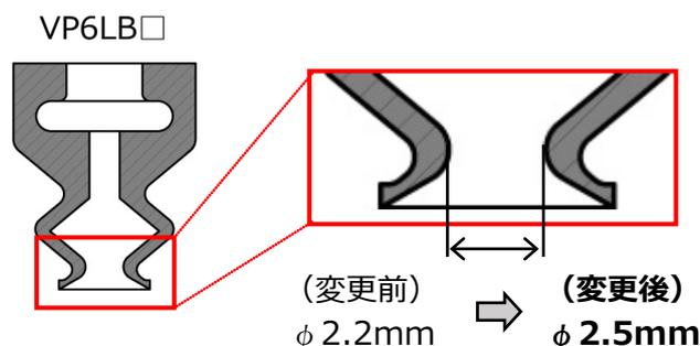
表面硬度の変更 (材質：ニトリルのみ)
